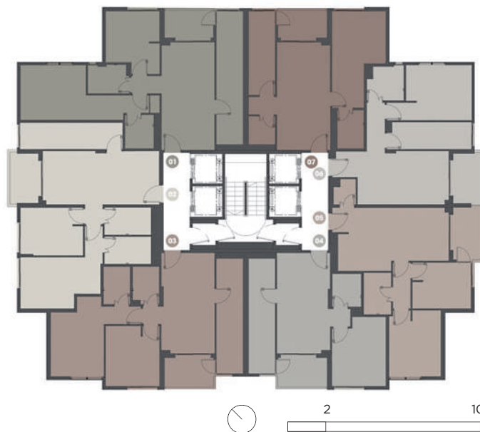
PLANTA TIPO TORRE GALLO. Pisos 8° a 19°.
